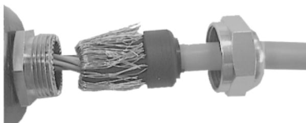
Fig. 31: Ligue a blindagem no bucim do cabo do encoder
