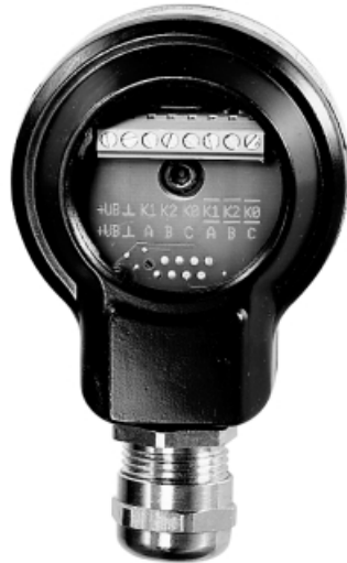
Fig. 32: Terminais de ligação dos encoders do motor SEW
