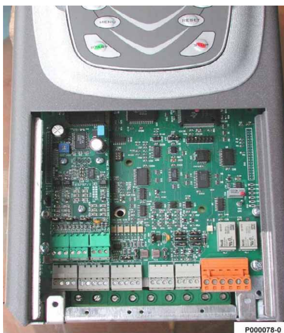
Figura 79: Placa de encoder fixada no slot
