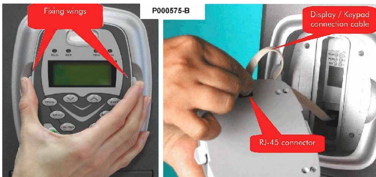
Figura 69: Remoção do módulo teclado
