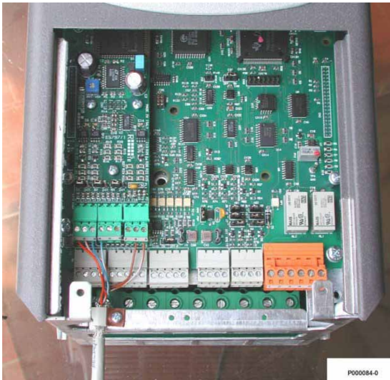
Figura 85: Conexão do cabo do encoder
