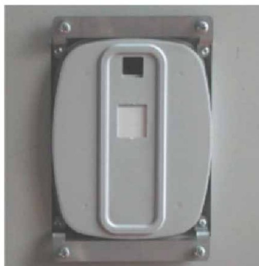
Figura 70: Vista anterior/posterior do teclado e relativa armação, fixados no painel.
